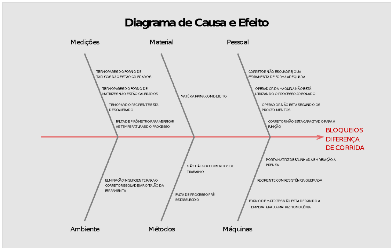
Figura 3 – Diagrama Causa-Efeito Bloqueios de Ferramentas
